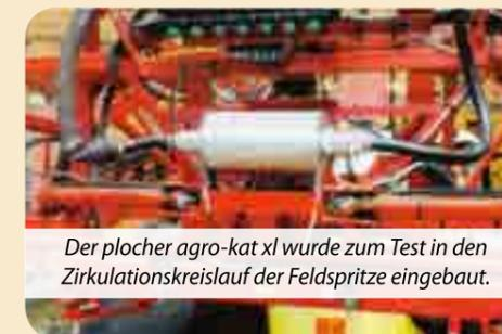
Der plocher agro-kat xl wurde zum Test in den Zirkulationskreislauf der Feldspritze eingebaut.
