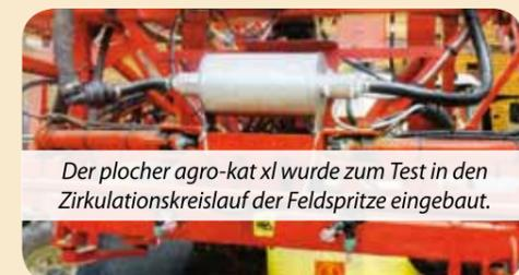
Der plocher agro-kat xl wurde zum Test in den Zirkulationskreislauf der Feldspritze eingebaut.
